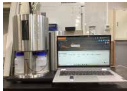
セルカウンター&アナライザーを用いた細胞密度と細胞径分布の測定
