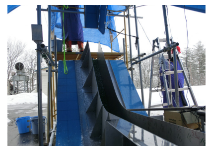
模型斜面を用いた人工雪崩実験の様子
