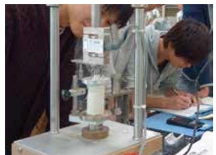
土の供試体の圧縮試験
